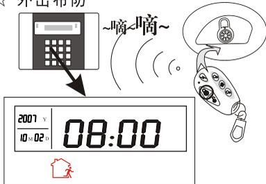
按遥控器的外出布防按钮，或按键盘上的“外出”布防键，会听到语音提示“系统外出布防”紧接着会听到“嘀~嘀”延时提示音，语音提示“系统布防请立即退出”，延时结束后，即布防成功。
