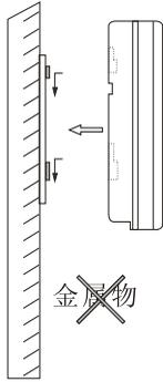
1. 主机周围不能放置较大的金属物品，以免影响无线探测器的信号接收。
