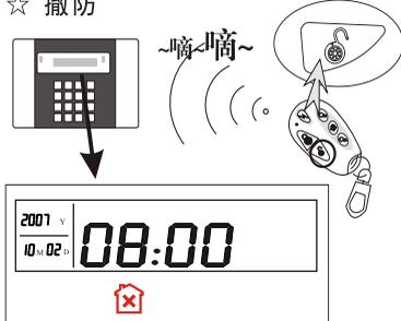
按遥控器的撤防按钮，或在键盘上输入您的用户密码按[#]确认，会听到一声脆响和“系统已撤防”语音，说明撤防成功。
