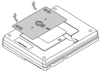
注：必须在断电状态下插入SIM卡。
