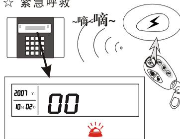
按遥控器的紧急呼救按钮，或按键盘上的“紧急/撤防”键3秒，主机会发出报警信号，10秒后您事先设置好的报警手机会被拨通。按撤防键消除报警。
