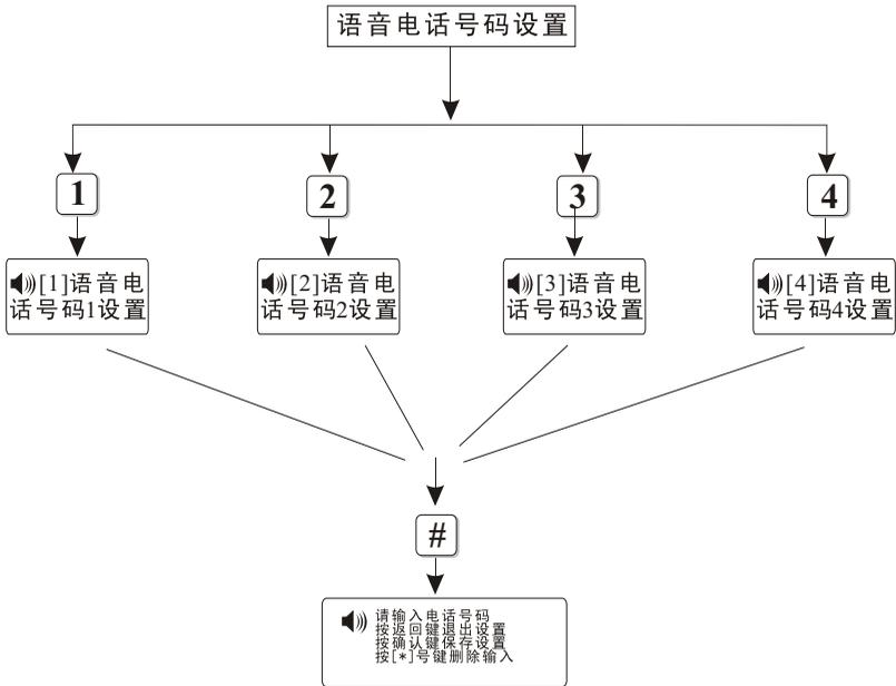
例2：主机接在一电话上，语音接警电话为本地电话“87654321”，要将该号码设置为第1个语音电话：（注：外地号码前请加当地区号，非当地手机号码，前面要加0）
