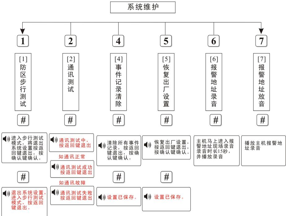
**步行测试：**测试探测器与主机是否正常工作 and 报警。在步行测试模式下，触发探测器，主机警号响约2秒，测试完成后，按【布防】键，主机退回到系统正常状态。
